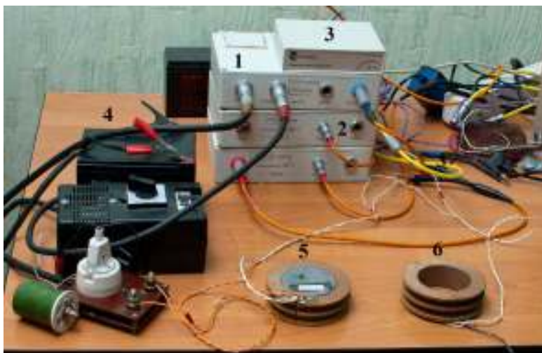
Рисунок 1 – Установка для измерения импульсных характеристик намагничности: 1 – коммутатор тока; 2 – измеритель; 3 – адаптер линии связи; 4 – аккумулятор, питающий генераторную обмотку; 5, 6 – катушки
